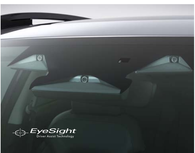
Plašu spektru aptverošas videokameras, kas atpazīst gājējus un riteņbraucējus
